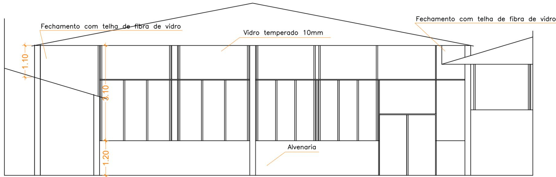
① ELEVAÇÃO FRONTAL - INSTALAÇÃO DE VIDROS
