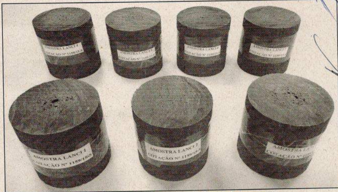
Figura 1 – Corpos de prova fornecidos para o ensaio de compressão
