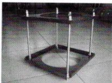
Armadura de aço para concreto da base
