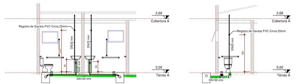
3 **Detalhe Instalação Lavatórios**
