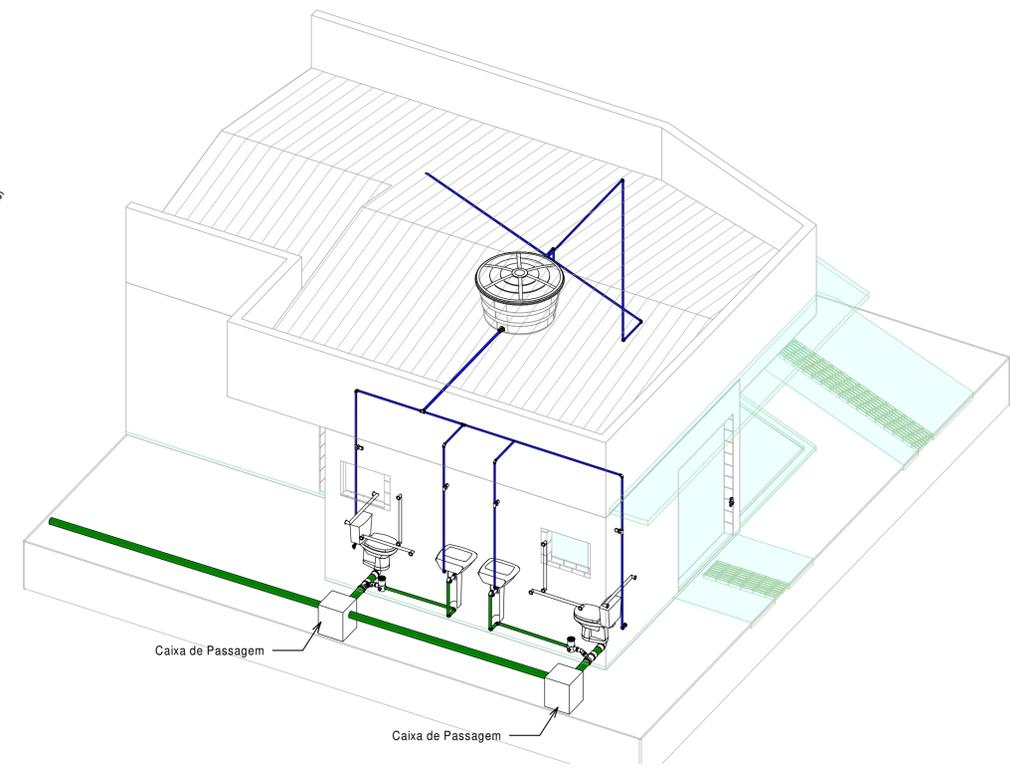
2 **Esquema 3D da Instalação Hidrossanitária**
