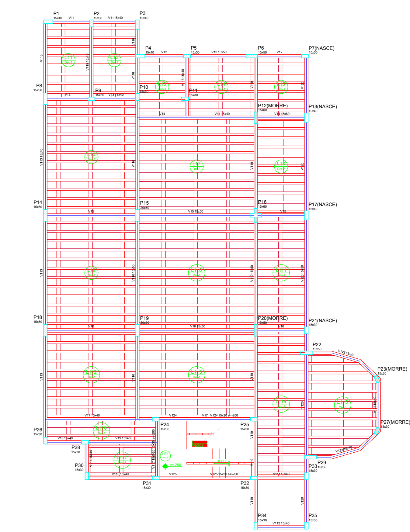
4 Planta de Formas do Pavimento Térreo Esc.: 1/100
