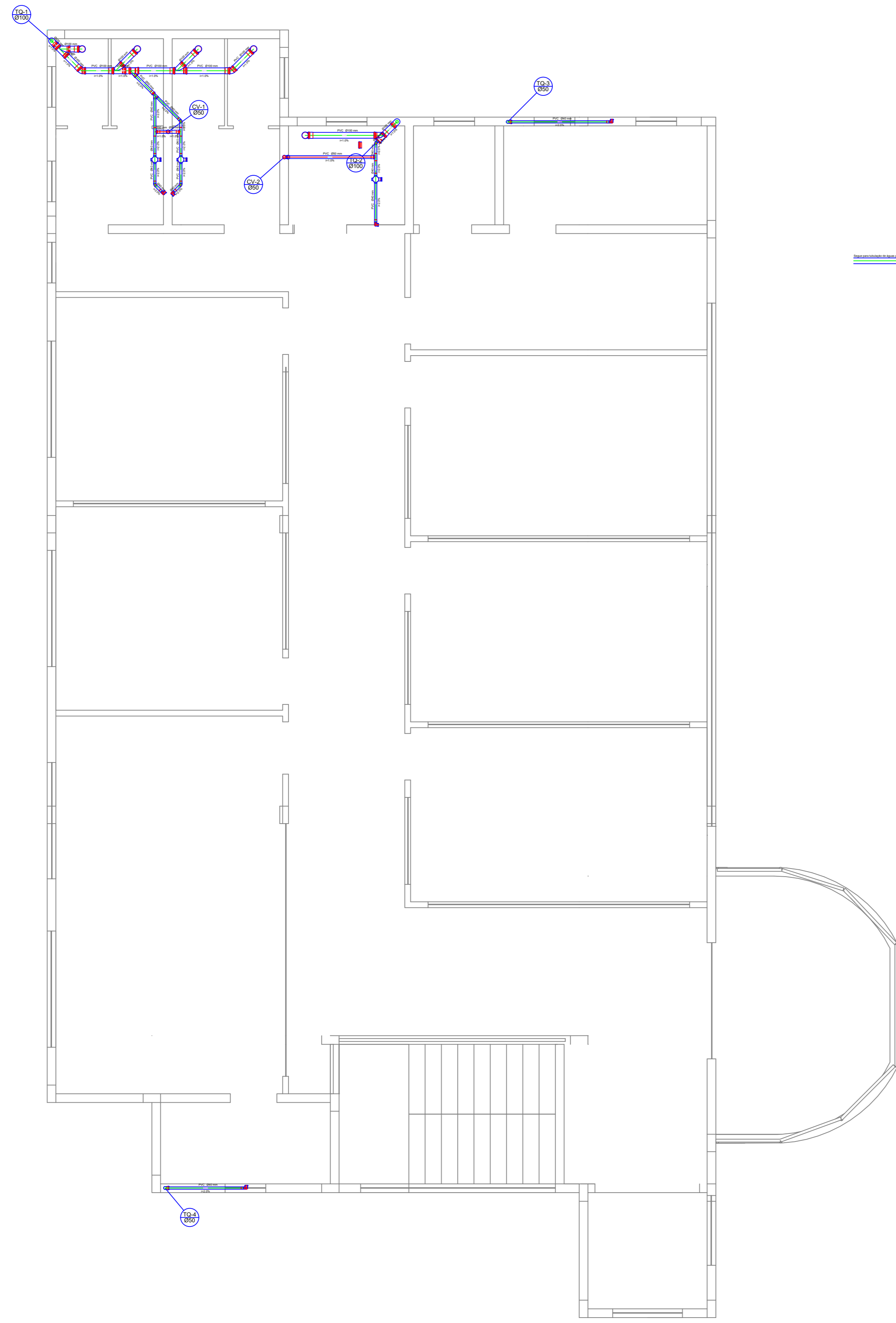
9 Planta Esgoto do Pavimento Superior Esc: 1:50
